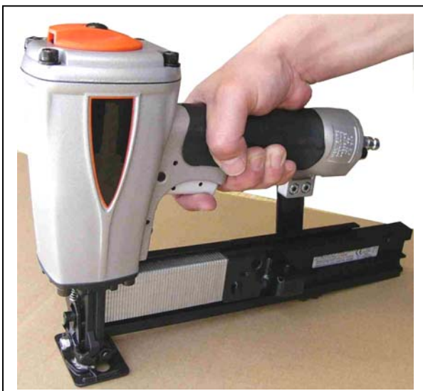
Klammergerät mit POGOSTICK – Heftauslösung über pneumatisches Ventil am oberen Haltegriff.
