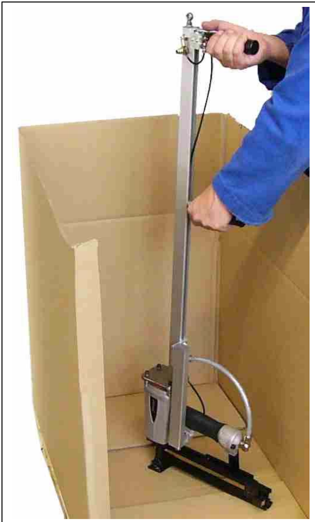
Klammergerät mit POGOSTICK – Heftauslösung über pneumatisches Ventil am oberen Haltegriff.
