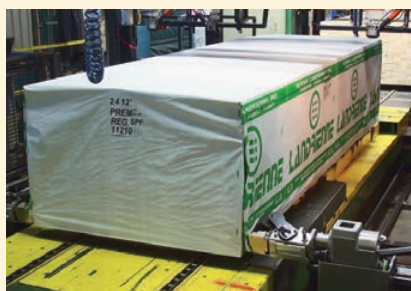
Полностью автоматизированное крепление защитного брезента в древесном крое
