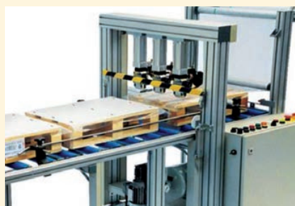
Крепление пленки и картона гвоздями на деревянном поддоне
