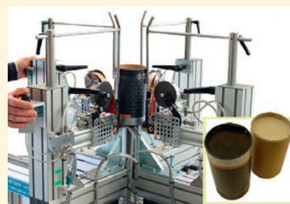
Запечатывание картонных труб, включая оснастку укладки
