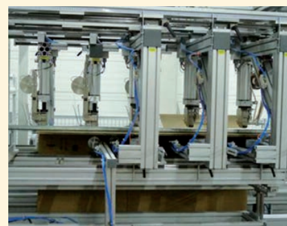
Закрепление втулок на готовых PAL-боксах
