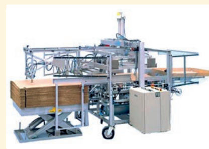
Степлерный механизм SHA: автоматическое скрепление насадных днищ и крышек
