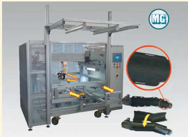
Крепление акустических капсул по периметру пластмассовых труб
