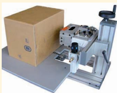
Примеры запечатывания картонной тары в различных позициях (сверху, снизу, сбоку), в идеальном случае для 2-слойного гофрированного картона
