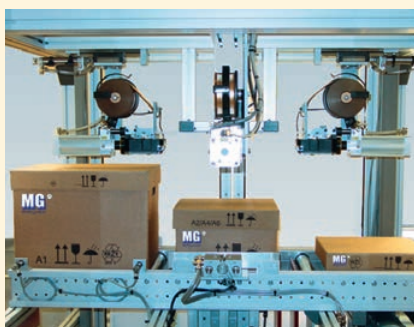
Примеры запечатывания картонной тары в различных позициях (сверху, снизу, сбоку), в идеальном случае для 2-слойного гофрированного картона
