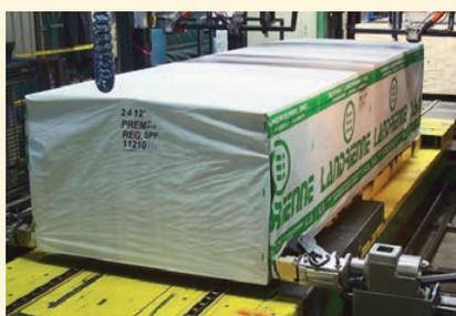
Fissaggio automatico di un telone di protezione sugli elementi di legno
