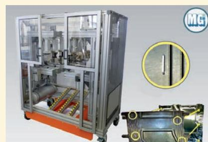
Fissaggio di lamiere di alluminio sui rivestimenti di materiale sintetico
