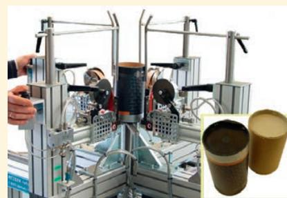
chiusura dei tubi di cartone tramite graffatura, ivi compreso il dispositivo di inserimento
