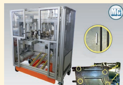
Fixieren von Aluminiumblechen auf Kunststoffverkleidungen
