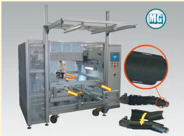
Fixieren von Akustikkapseln um Kunststoffrohr
