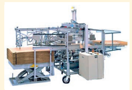
SHA-Heftmaschine: automatische Stülpboden- und Stülpdeckelheftung
