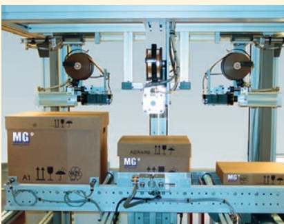
Beispiele für einen Kartonverschluss in verschiedenen Positionen (oben, unten, seitlich), idealerweise für einen 2-welligen Karton
