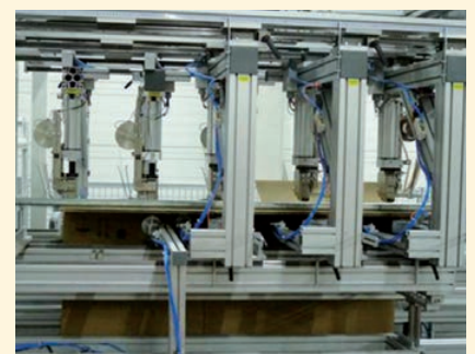
Heftverbindung von Hülsen zu fertiger PAL-Box
